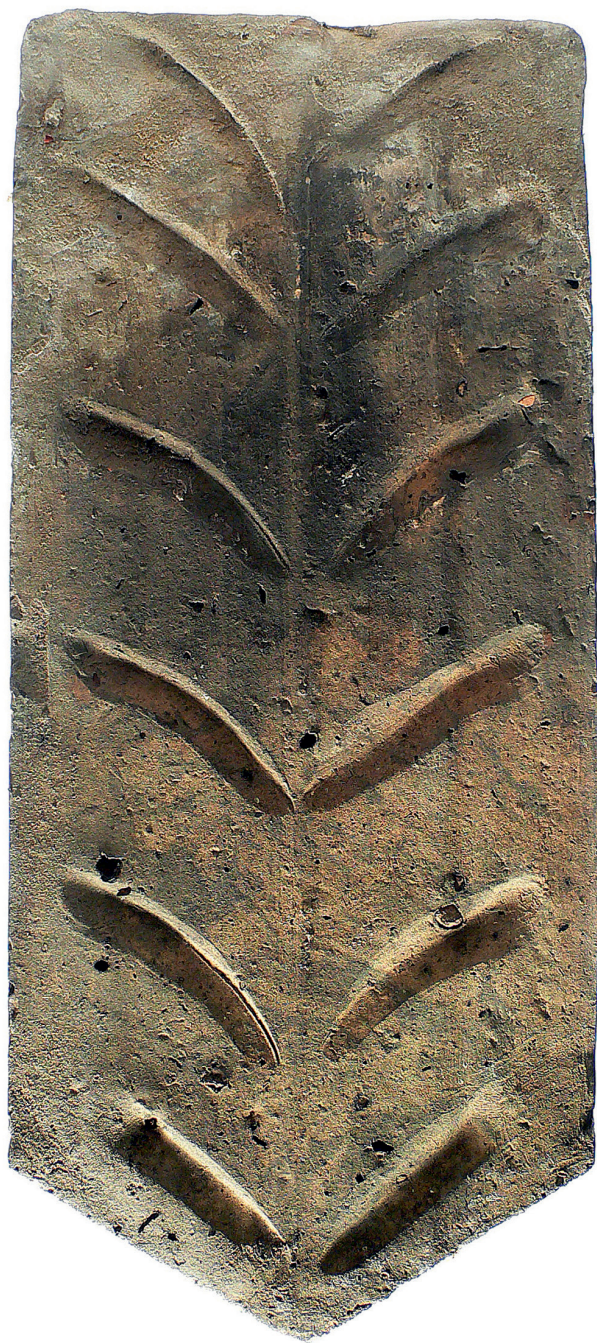
La pointe avec l'ornement en chevrons ou en sapin date probablement du 19 e siècle. L'ornement appliqué avec les doigts se retrouve souvent sur des tuiles faites à la main.
