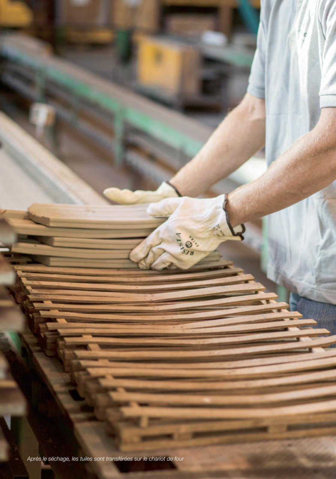
*Après le séchage, les tuiles sont transférées sur le chariot de four*
