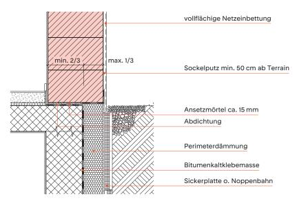
Statischer Nachweis für reduzierte Auflagefläche Mauerwerk durch Ingenieur zu erbringen.
