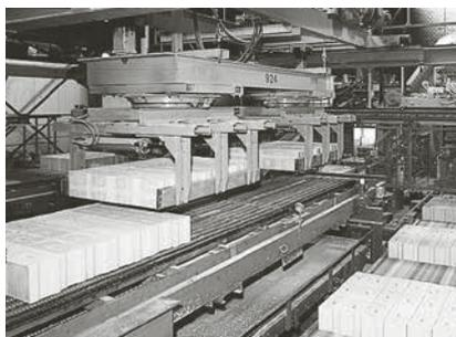
Mit der Umstockanlage werden die fertigen Backsteine palettiert.
