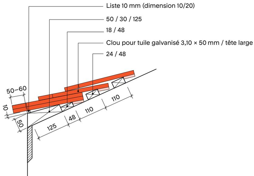
Cheneau: Casta tuile de tourelle / Double gouttière -> Tôle d'entrée AVEC gouttière
