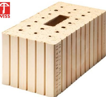
Backstein für Einsteinauerwerk, mechanische Eigenschaften gemäss Deklaration, schalldämmend (vgl. SIA Norm 266). Der Backstein Calmo wird mit einem geringen Lochflächenanteil sowie mit einer erhöhten Trockenrohddichte produziert. Durch die erhöhte Masse können sowohl der Luftschall als auch der Körperschall wesentlich eingedämmt werden.
