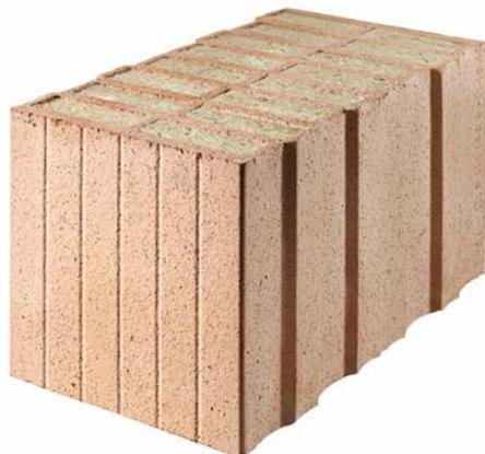
Porotherm FZ8 sind geschliffene, wärme-dämmende Leichtbacksteine mit Mineralwollefüllung. Dieses Mauerwerk wird nur mit einer dünnen Lagerfuge geklebt erstellt und damit gelangt kaum Feuchtigkeit in das Gebäude. Das Porotherm-Mauerwerk erlaubt einen einschaligen Fassadenaufbau bei ein- und mehrgeschossigen Bauten.
