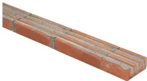
Les linteaux en terre cuite constitués de briques de terre cuite de haute qualité sont précontraints dans le banc et scellés au mortier spécial.
