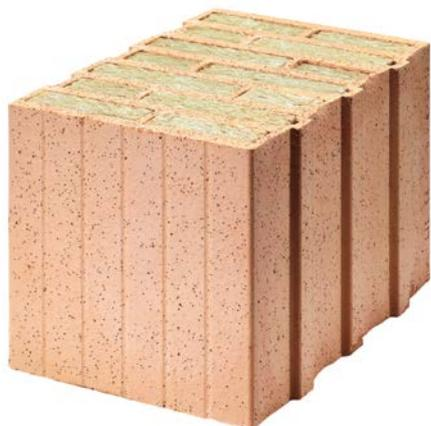
Porotherm FZ7, ce sont des briques légères polies et isolantes thermiquement avec remplissage en laine minérale. La maçonnerie n'est collée qu'avec une fine couche de joint, ce qui limite la pénétration d'humidité dans l'ouvrage. La maçonnerie Porotherm autorise la construction monobloc de la façade sur des ouvrages d'un ou plusieurs étages.
