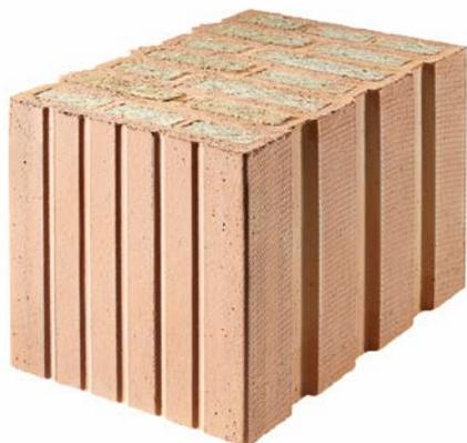
Porotherm FZ9, ce sont des briques légères polies et isolantes thermiquement avec remplissage en laine minérale. Ces briques sont spécialement optimisées pour les exigences d'isolation phonique ainsi que de statique. La maçonnerie n'est collée qu'avec une fine couche de joint, ce qui limite la pénétration d'humidité dans l'ouvrage. La maçonnerie Porotherm autorise la construction monobloc de la façade sur des ouvrages de plusieurs étages.
