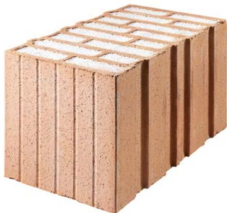
Porotherm T7 sind geschliffene, hoch wärme-dämmende Leichtbacksteine mit Perlit-füllung. Dieses Mauerwerk wird nur mit einer dünnen Lagerfuge geklebt erstellt und damit gelangt kaum Feuchtigkeit in das Ge-bäude. Das Porotherm-Mauerwerk er-laubt einen einschaligen Fassadenaufbau bei ein- und mehrgeschossigen Bauten.
