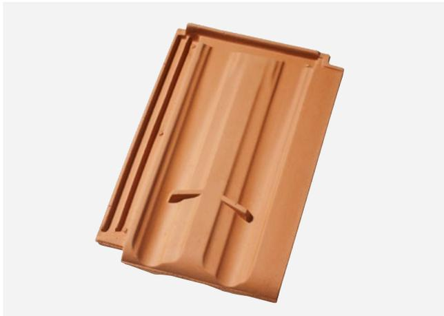
Die zwei horizontalen Schneefangnasen machen das Modell Monteso zu einem einzigartigen Bergmuldenschiebeziegel im Grossformat. Mit einem Bedarf von 10 Ziegeln pro Quadratmeter ist er in seiner Kategorie ausserdem äusserst wirtschaftlich. Dank der hoch entwickelten Form unterstützt der Monteso in voralpinen und alpinen Zonen zusätzlich zu Schneefangsicherungen den Schneerückhalt.
